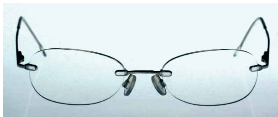
Lediglich vier Mikroteile aus 0,04 Gramm Polyamid-Copolymer und ein Spezialklebstoff sind notwendig, um die Vorteile der Lensbond -Klebebrillentechnik auf randlose Titanbrillen zu übertragen.
