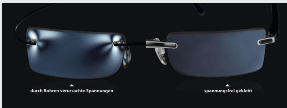
Polarisiertes Licht macht die Spannungszustände im Glas sichtbar. Der Vergleich mit der gebohrten Brille (links) zeigt, dass die Klebeverbindungen (rechts) keine Spannungen ins Glas einleiten (Bilder: Lensbond)
