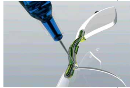
Die Klebeverbindung zwischen den Halteteilen und den Gläsern wird durch lokales Abfräsen der Lotuseffekt-Glasbeschichtung und Nutzung des Kapillareffektes bei der Klebstoffverteilung in einer Haltevorrichtung hergestellt.
