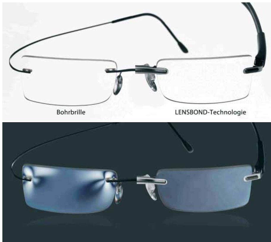
Vergleich einer Glasfixierung mittels über Bohrungen im Glas (Bohrbrille) und über Klebverbindungen (Lensbond-Technologie). Mit monochromem, polarisiertem Licht werden die resultierenden Spannungszustände im Glas sichtbar gemacht. Der Vergleich zeigt, dass die Klebverbindungen keine Spannungen ins Glas einleiten.
