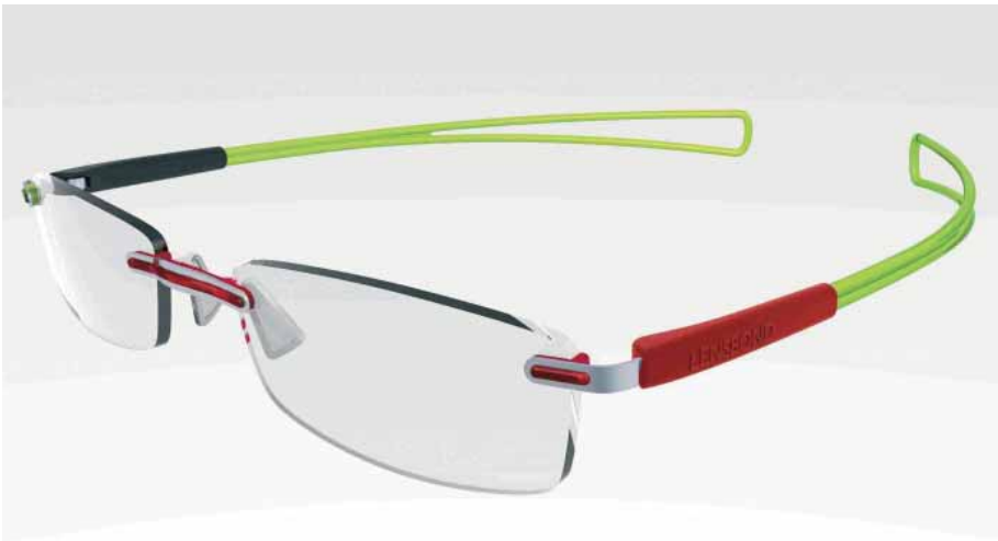
Die Klebeverbindung zwischen den Halteteilen und den Gläsern wird durch lokales Abfräsen der Lotuseffekt-Glasbeschichtung und Nutzung des Kapillareffektes bei der Klebstoffverteilung in einer Haltevorrichtung hergestellt.
